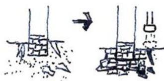
增加基础、夯实周边墙体
