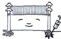
加固基础土质、基础注浆、增加基础
